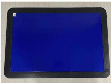
DMFを積層～断裁加工により積層マットを製造。
